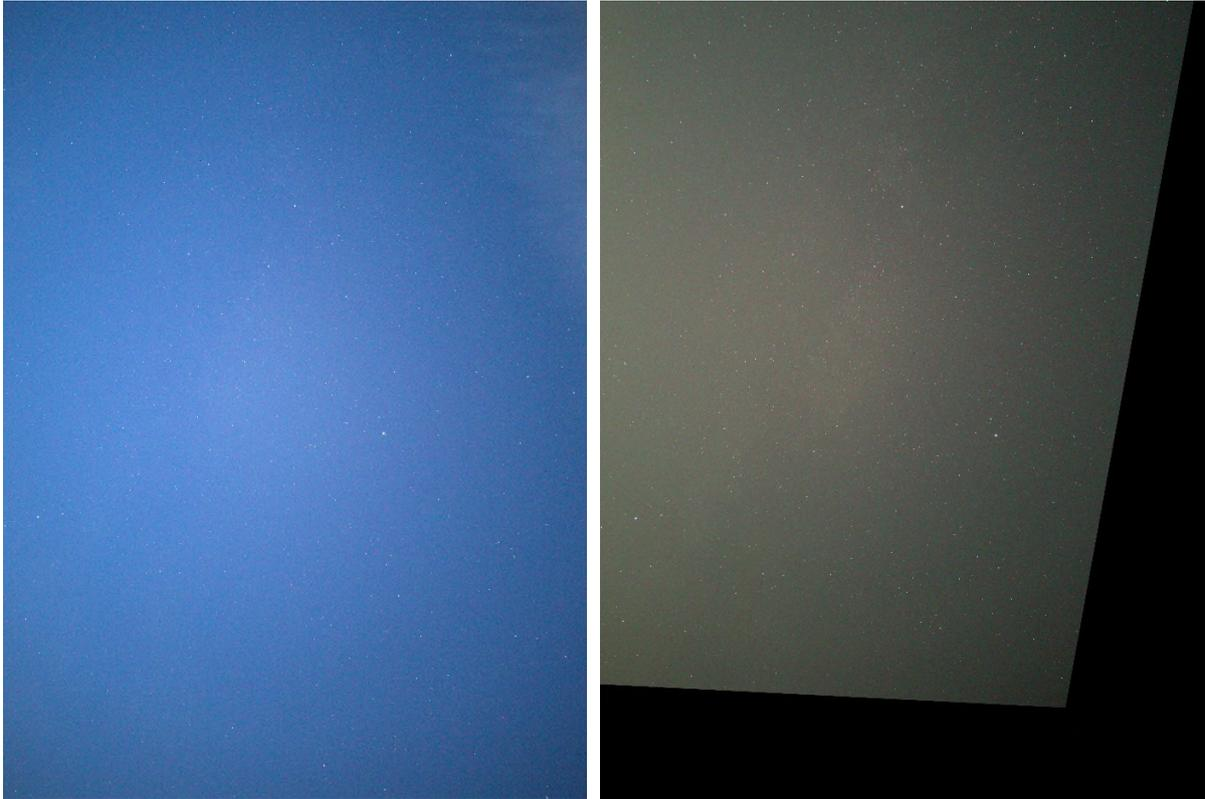
Durch die Ausrichtung der nicht nachgeführten Bilder entstehen diese schwarzen Artefakte an den Rändern. Die Artefakte werden immer größer, je mehr Bilder Sie aufnehmen. Es gibt ein Maximum an Bildern, die Sie stacken können. Wenn die Referenzsterne vollständig aus dem Bild herausgewandert sind, schlägt die Analyse fehl oder erzeugt verzerrte Bilder (siehe Kapitel "Verzerrtes Stacking-Ergebnis").
